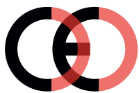
Virheellinen CE-merkki (liian lähellä)
