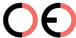
Virheellinen CE-merkki (liian kaukana)
